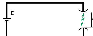
Fig. 2: El arco eléctrico y la influencia del campo E/d .
